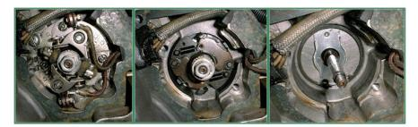
Abbildung 2 Demontage der alten Zündungskomponenten.
