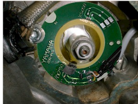
Abbildung 2 Demontage der alten Zündungskomponenten.
