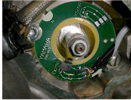
Danach erfolgt der Einbau der Leiterplatte.
