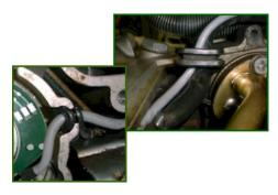
Die Kabelführung erfolgt a) durch das beigefügte Durchführungsgummi und b) durch die originale Kabeldichtung nach außen.
