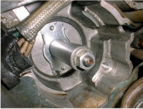
Als nächstes wird der Mitnehmer auf die Achse geschoben und mit der Mutter befestigt.
