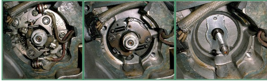
Abbildung 2 Demontage der alten Zündungskomponenten.
