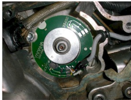
Zuletzt wird den Magnetring auf den Mitnehmer geschoben, aber die Madenschrauben in dem Magnetring noch nicht festziehen.
