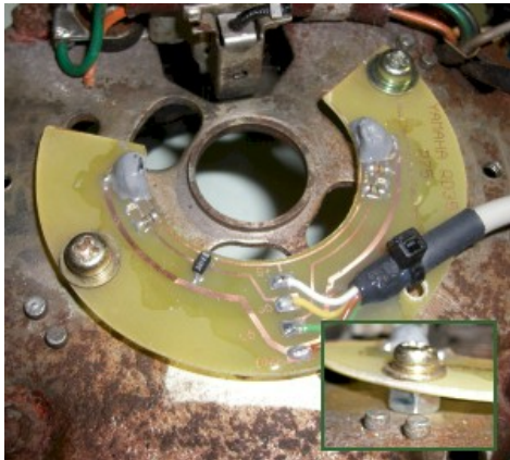
Montage auf der Stahl-Lichtmaschine
