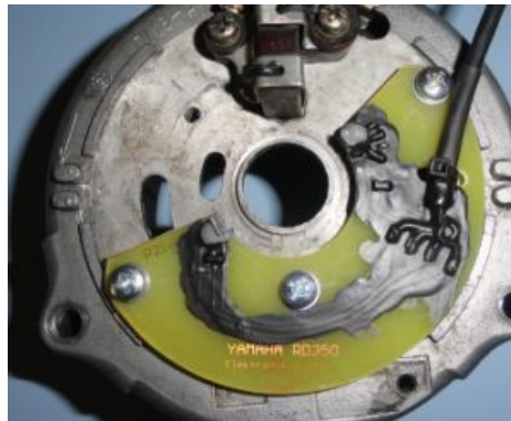
Montage der Sensorplatte auf der Alu-Lichtmaschine
