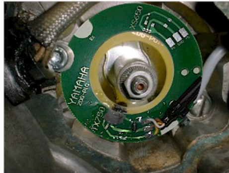
Abbildung 2 Zuerst die originale Kontaktplatte und den Fliehkraftregler ausbauen.
