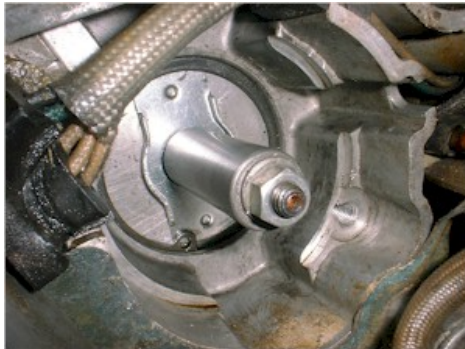
Abbildung 2 Zuerst die originale Kontaktplatte und den Fliehkraftregler ausbauen.
