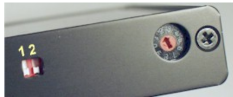
Abbildung 6 DIP-Schalter und Drehschalter.
