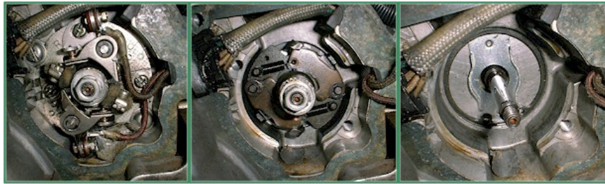
Abbildung 2 Zuerst die originale Kontaktplatte und den Fliehkraftregler ausbauen.
