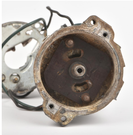
Abbildung 3 Der leere Verteiler.
