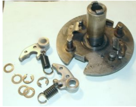
Abbildung 2 Demontage des alten Fliehkraftreglers.
