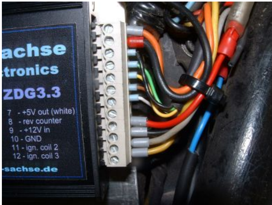
Abbildung 3 Montage der Zündbox und des Anschlußsteckers.
