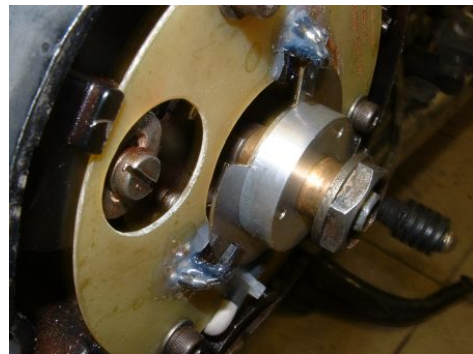
Abbildung 2 Ausrichtung von Magnetring zu Pickup (Bild zeigt ältere Version als ausgeliefert).
