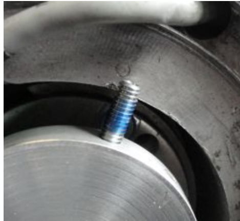
Abbildung 7 Für die Madenschrauben mittelfesten Schraubensicherungslack benutzen.
