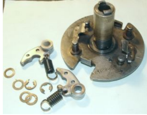
Abbildung 2 Demontage des alten Fliehkraftreglers.
