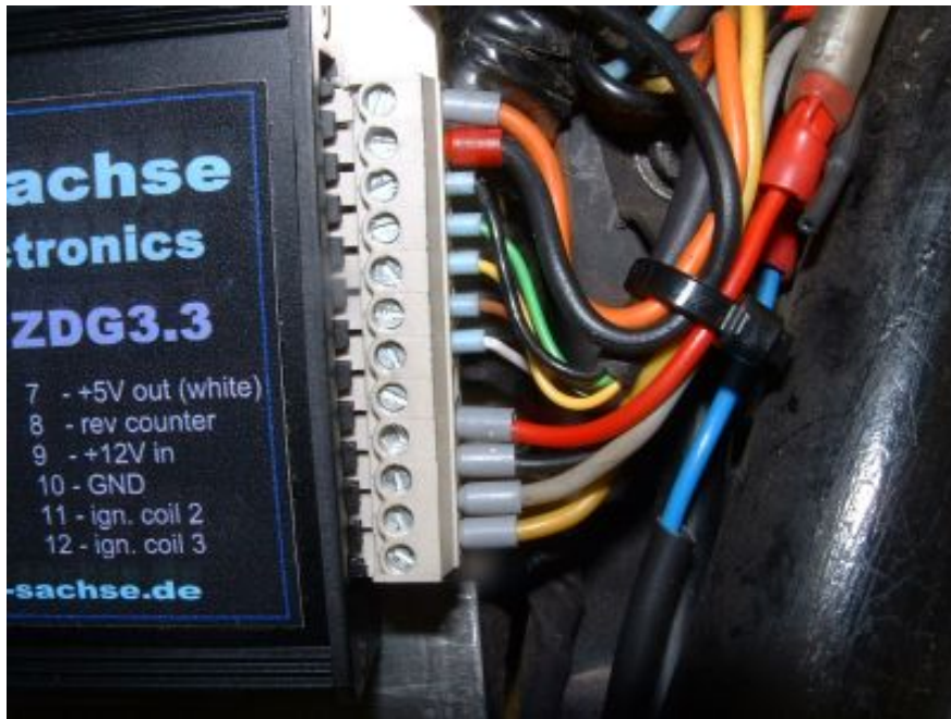
Abbildung 3 Montage der Zündbox und des Anschlußsteckers.
