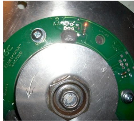
Abbildung 8 Beim Vorbeilaufen des S-Magnetes geht die LED an.
