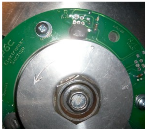
Abbildung 8 Beim Vorbeilaufen des N-Magnetes geht die LED aus.
