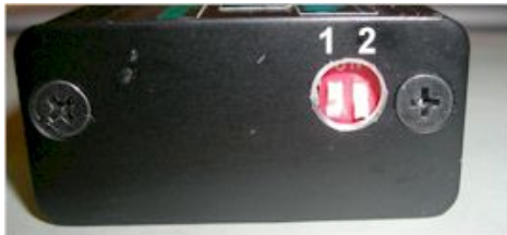
Abbildung 4 DIP-Schalter und Zündkurvenauswahl.
