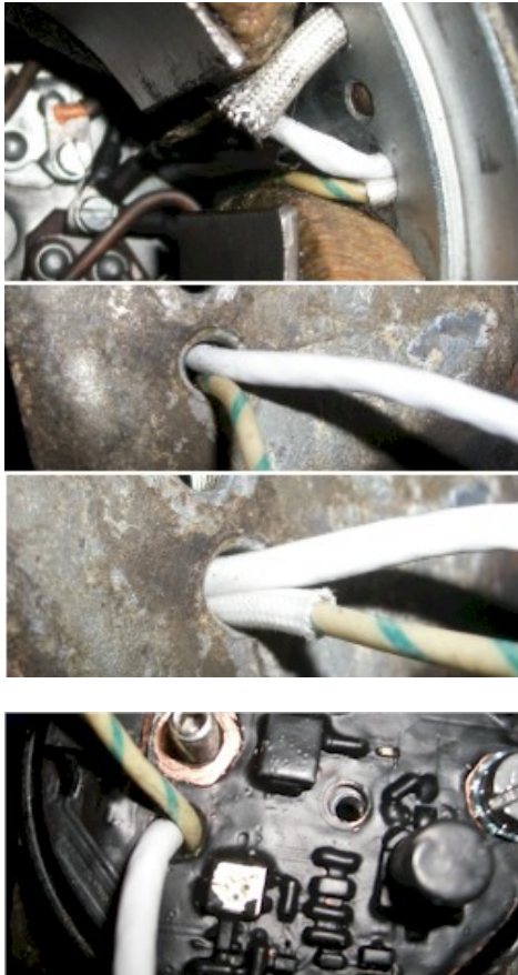
Kabelführung durch die Reglergrundplatte mit dem Lichtmaschinenregler RegKS (nicht mehr lieferbar)
