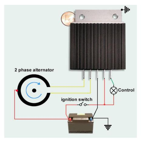
Abbildung 2 Schematische Übersicht über den Anschluss.
