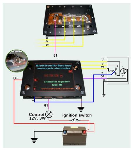
Abbildung 1 Schematische Darstellung des Regleranschlusses
