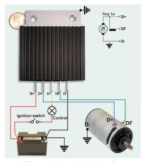
Abbildung 1 Schematische Darstellung des Regleranschlusses
