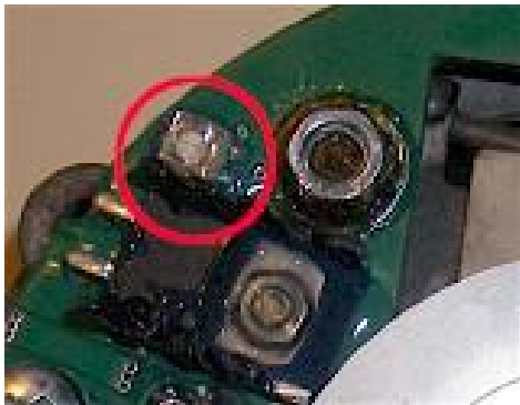
Abbildung 7 Poti zum Einstellen der Ladespannung.
