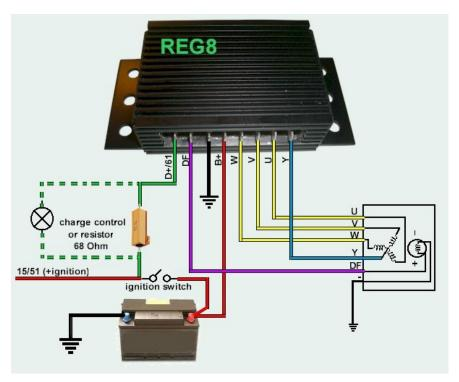
Abbildung 1 Schematische Darstellung des Regleranschlusses
