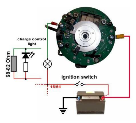
Abbildung 8 Schematische Darstellung des Regleranschlusses.
