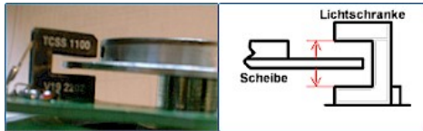
Abbildung 14 Ausrichtung der Sektorscheibe in der Lichtschranke
