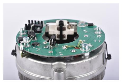
Abbildung 6 Montierter Regler
