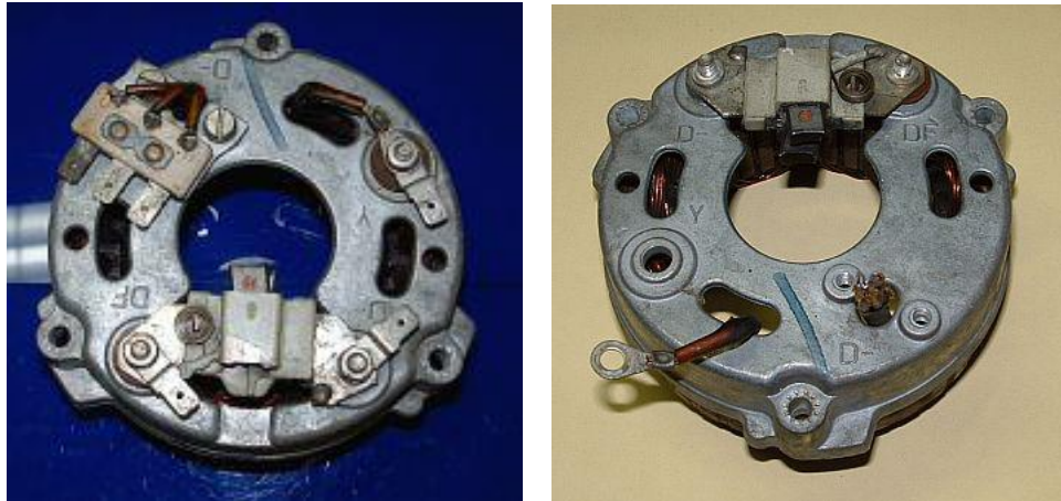
Abbildung 2 Entfernen des Anschlussblocks und der Y-Verbindung
