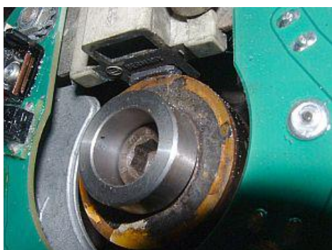
Abbildung 7 Montage des Stators und Mitnehmers.
