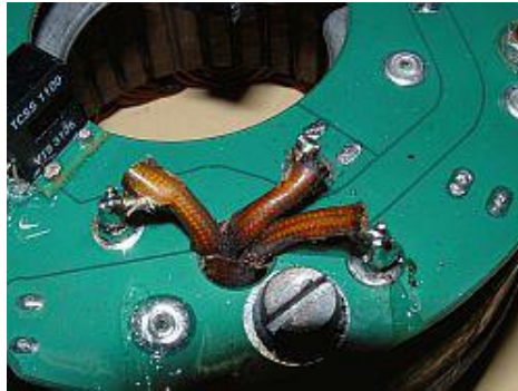
Abbildung 3.b Anlöten der drei Statorphasen
