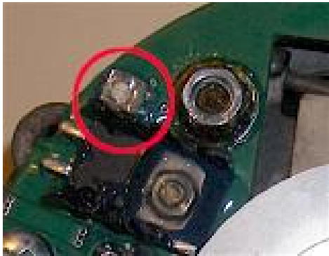
Abbildung 17 Poti zum Einstellen der Ladespannung
