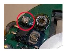
**Abbildung 17** Poti zum Einstellen der Ladespannung
