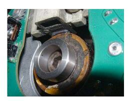
Abbildung 7 Montage des Stators und Mitnehmers.
