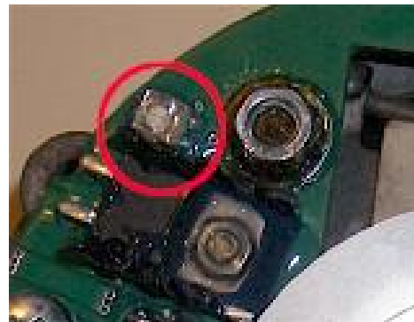
Abbildung 17 Poti zum Einstellen der Ladespannung
