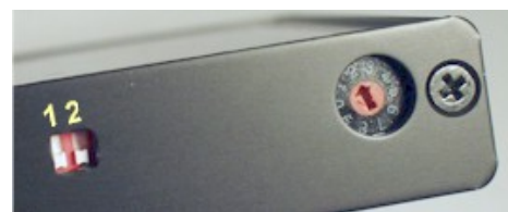
Abbildung 15 DIP-Schalter und Drehschalter.
