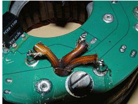
Abbildung 3 Anlöten der drei Statorphasen
