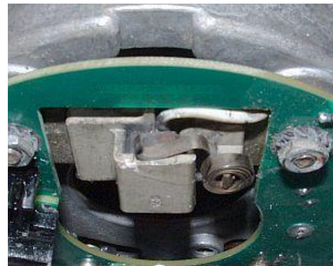
Abbildung 5 Aushängen der Kohlenfeder
