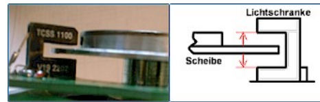
Abbildung 14 Ausrichtung der Sektorscheibe in der Lichtschranke
