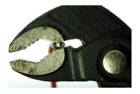
Crimpen mit einer Wasserpumpenzange.
