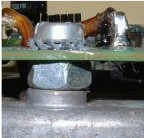
Abbildung 3 M6-Mutter als Distanzstück
