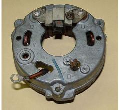
Abbildung 2 Entfernen des Anschlussblocks und der Y-Verbindung
