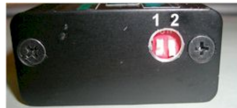
Abbildung 4 DIP-Schalter und Zündkurvenauswahl.
