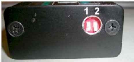
Abbildung 5 DIP-Schalter und Zündkurvenauswahl.
