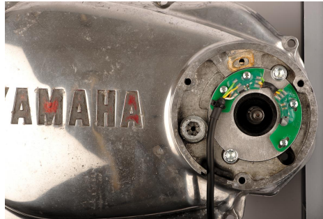
Die Pickupträgerplatte wird mit den M6-Schrauben und den zugehörigen Muttern befestigt. Wenn das Kabel nur schwer durch die Kabeldurchführung paßt, hilft ein Tropfen Spülmittel.
