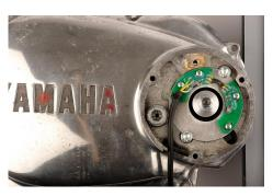
Der Mitnehmer wird über die Welle geschoben und mittels Mutter und Unterlegscheibe gesichert.
