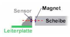
Abbildung 3 Korrekte Ausrichtung von Magnetring und Sensor.
