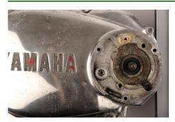
Die Kontaktplatte und der Fliehkraftregler wird entfernt. Beides wird nicht mehr benötigt.
