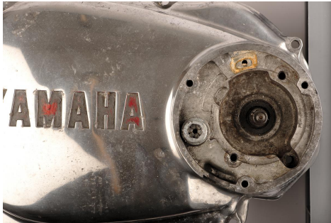
Die Kontaktplatte und der Fliehkraftregler wird entfernt. Beides wird nicht mehr benötigt.
