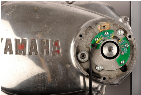
Der Mitnehmer wird über die Welle geschoben und mittels Mutter und Unterlegscheibe gesichert.
