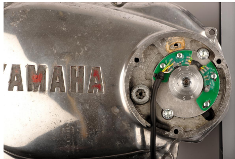
Der Magnetring wird montiert indem er über den Mitnehmer geschoben wird. Die Madenschrauben brauchen noch nicht angezogen zu werden.
