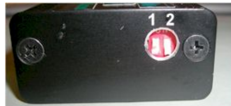
Abbildung 4 DIP-Schalter und Zündkurvenauswahl.
