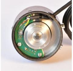
Nun wird der Magnetring über den Mitnehmer geschoben. Die Madenschrauben werden noch nicht angezogen. Der Magnetring kann sich also locker auf dem Mitnehmer drehen. Er wird später erst angezogen.
