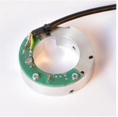
Dies ist das neue Pickup mit Trägerplatte welches nun in dem Verteiler montiert wird.
