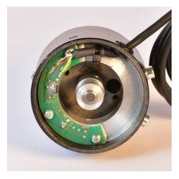
Die Pickupträgerplatte wird mit den M4-Schrauben befestigt. Das Anschlußkabel wird durch die vorhandene Öffnung im Verteiler geführt. Eine Durchführungstülle verhindert eine Beschädigung des Kabels.
