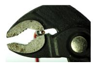
Crimpen mit einer Wasserpumpenzange.
