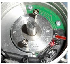
Wenn der Magnetring zwei Paare N- und S-Magnete haben sollte, ist es nicht relevant, welches Paar für die Grundeinstellung benutzt wird. Ebenso ist es nicht relevant, welcher OT (Kompressions- oder Ausstoßtakt) für die Grundeinstellung verwendet wird.
