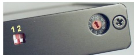
Abbildung 5 DIP-Schalter und Drehschalter.
