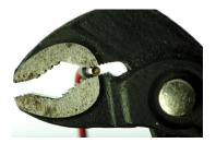
Crimpen mit einer Wasserpumpenzange.
