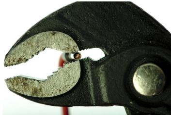
Crimpen mit einer Wasserpumpenzange.
