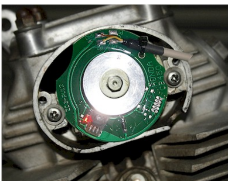
Montage der Sensorplatte (Fotomontage)
