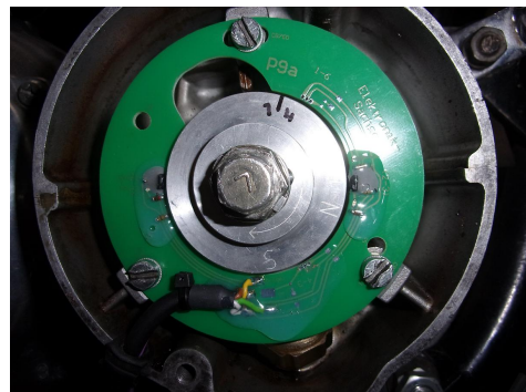
Abbildung 2 Montage des neuen Pickups, Mitnehmers und des Magnetringes. Die Madenschrauben im Magnetring noch nicht anziehen.
