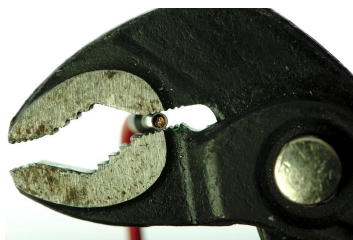
Crimpen mit einer Wasserpumpenzange.
