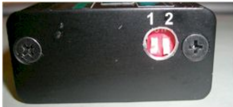
Abbildung 8 DIP-Schalter und Zündkurvenauswahl.
