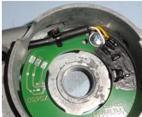
Abbildung 2 Montage des Pickups.
