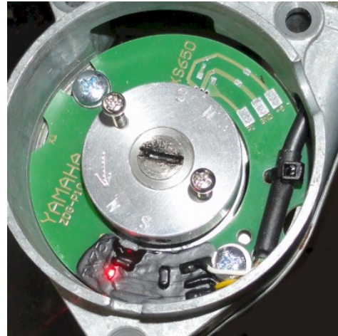
Abbildung 6 Die LED geht an wenn der S-Magnet am Sensor vorbeiläuft und aus wenn der N-Magnet am Sensor vorbeiläuft.
