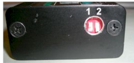
Abbildung 8 DIP-Schalter und Zündkurvenauswahl.
