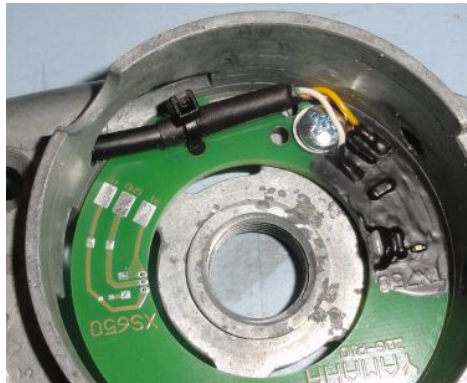
Abbildung 2 Montage des Pickups.
