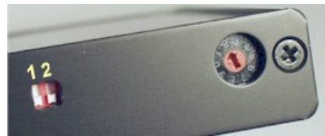
Abbildung 8 DIP-Schalter und Drehschalter.
