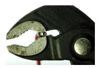
Crimpen mit einer Wasserpumpenzange.
