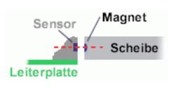
Abbildung 5 Korrekte Ausrichtung von Magnetring und Sensor.
