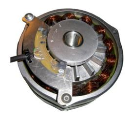
Abbildung 5 Montage des Pickups.
