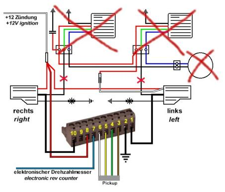
Abbildung 6 Anschlußschema der Zündung bei Motoplat-Ersatz
