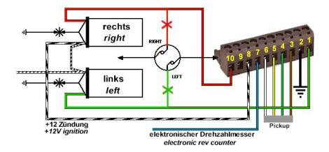
Abbildung 7 Anschlußschema der Zündung bei Kontaktersatz
