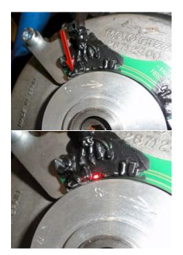
Abbildung 9 Ausrichten des Magnetringes so daß die LED gerade an- bzw. ausgeht.
