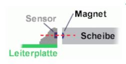
Abbildung 4 Korrekte Ausrichtung von Magnetring und Sensor.
