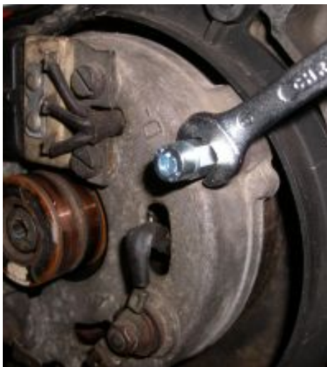
Abbildung 4.e Montieren des Sechskantes auf den Gewindestangen
