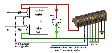
Abbildung 6 Anschlußschema der Zündung bei Kontaktersatz
