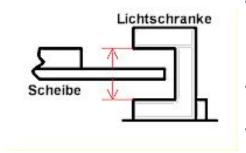
Abbildung 9 Ausrichtung von Sektorscheibe und Lichtschranke.
