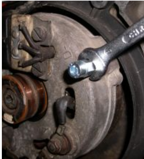
Abbildung 4 Montieren des Sechskantes auf den Gewindestangen
