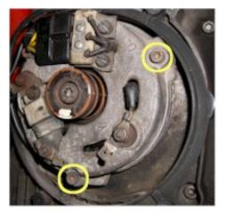
Abbildung 4 Anschlußpunkte des Pickups
