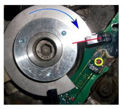
Abbildung 8 Ausrichten der Sektorscheibe so daß die LED gerade ausgeht.
