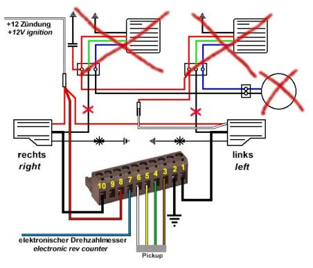
Abbildung 5 Anschlußschema der Zündung bei Motoplat-Ersatz
