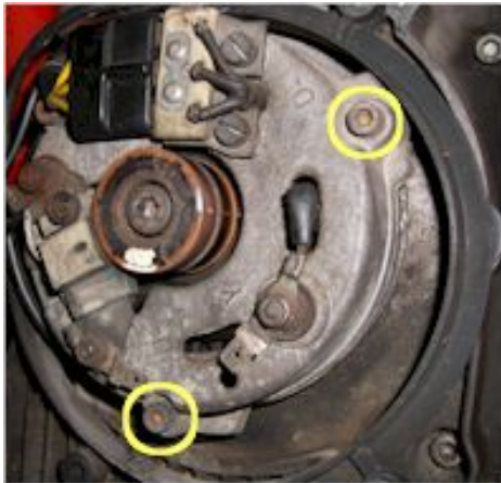
Abbildung 4.a Anschlußpunkte des Pickups
