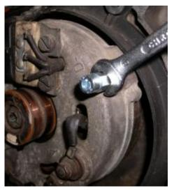
Abbildung 4 Montieren des Sechskantes auf den Gewindestangen
