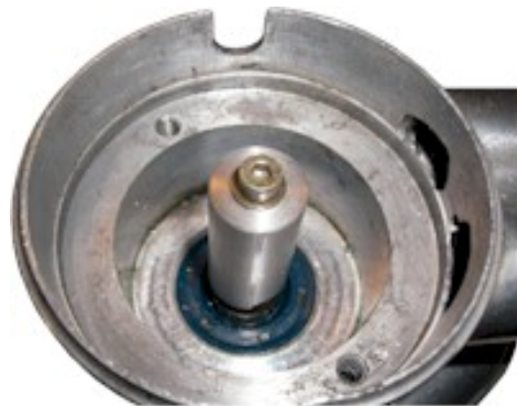
Abbildung 2 Montage des Mitnehmers auf der Welle.
