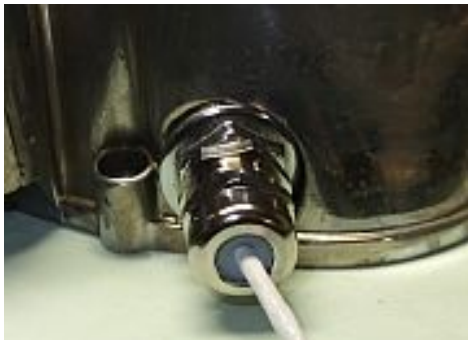
Kabeldurchführung mit Adapter.
