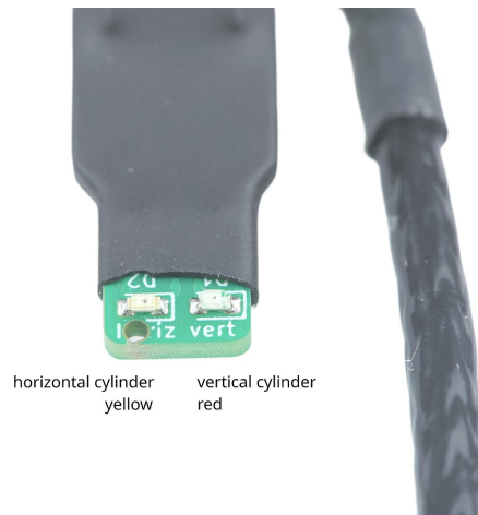
Abbildung 3 Die rote LED zeigt den vertikalen Zylinder an, die gelbe den horizontalen.
