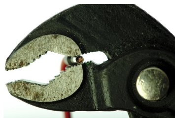
Crimpen mit einer Wasserpumpenzange.
