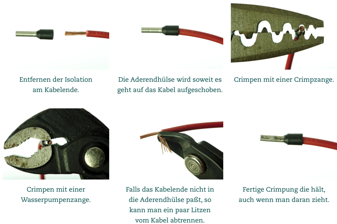
Abbildung 2 Crimpen der Aderendhülsen
