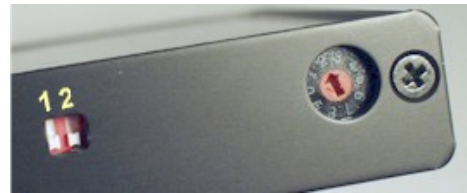
Abbildung 5 DIP-Schalter und Drehschalter.
