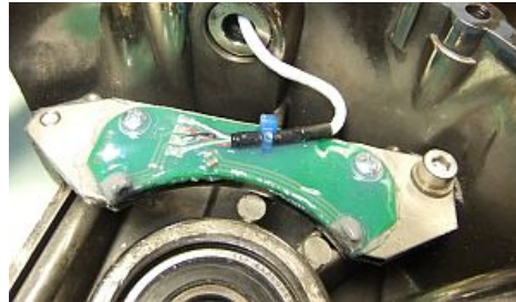
Montage des neuen Pickups.
