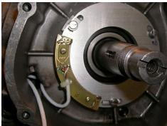
Befestigung des Magnetringes.
