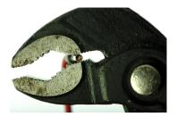
Crimpen mit einer Wasserpumpenzange.
