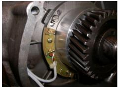
Befestigung des neuen Magnetringes am Primärzahnrad.
