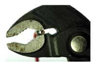
Crimpen mit einer Wasserpumpenzange.
