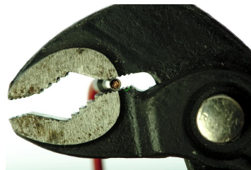
Crimpen mit einer Wasserpumpenzange.
