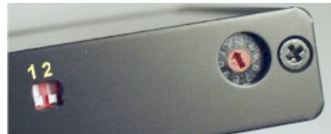
Abbildung 4 DIP-Schalter und Drehschalter.
