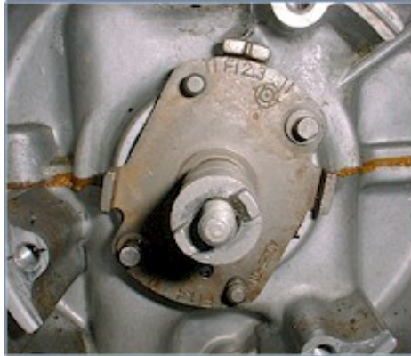
Abbildung 2 Nutzen des originalen Mitnehmers mit unserem Magnetring. Dies ist die bevorzugte Montage wenn kein Mitnehmer mitgeliefert wurde.
