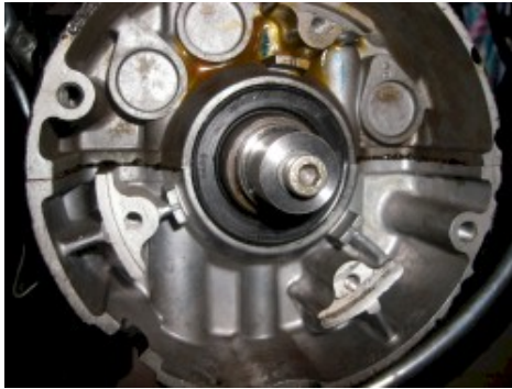
Abbildung 2 Mitnehmer montiert (etwas anderes Design als geliefert).
