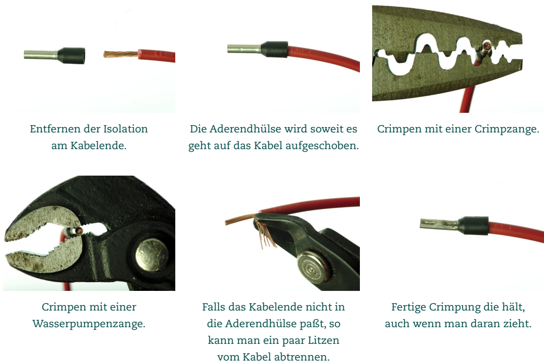
Abbildung 6 Crimpen der Aderendhülsen
