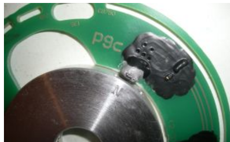
Abbildung 8 Die LED geht aus wenn der N-Magnet am Sensor vorbeiläuft.
