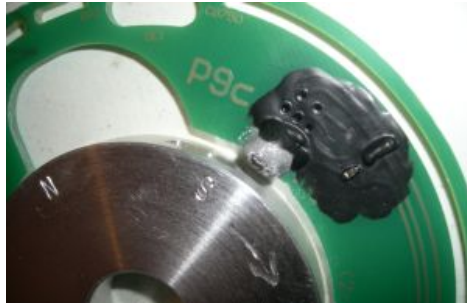
Abbildung 8 Der Magnetring wird so positioniert daß der S-Magnet kurz vor dem Sensor steht.
