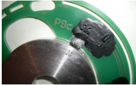
Abbildung 8 Die LED geht aus wenn der N-Magnet am Sensor vorbeiläuft.
