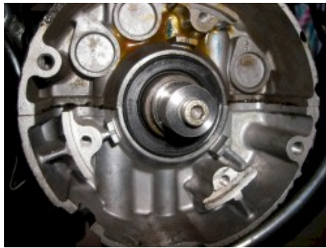
Abbildung 2 Mitnehmer montiert (etwas anderes Design als geliefert).
