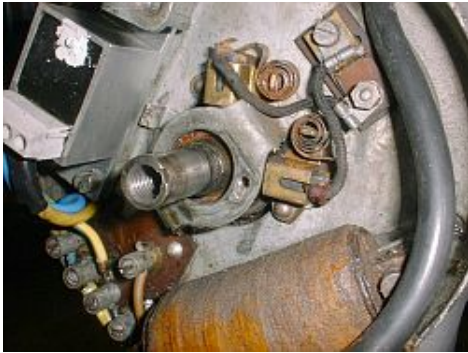
Die Leiterplatte wird mit Hilfe des Abstandshalters auf dem Lichtmaschinenstator montiert.
