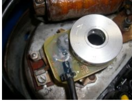
Die Rotormittelschraube entfernen und durch die mitgelieferte Inbusschraube und dem Mitnehmer ersetzen. Zuletzt wird der Magnetrings auf den Mitnehmer aufgeschoben, aber die Madenschrauben noch nicht festziehen.
