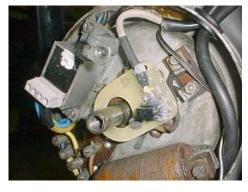
R27: Da die Montage auf der Lichtmaschine erfolgt, können Fliekraftregler und Kontakt montiert bleiben.
