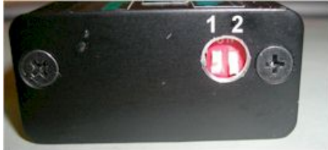
Abbildung 4 DIP-Schalter und Zündkurvenauswahl.
