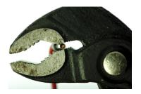
Crimpen mit einer Wasserpumpenzange.
