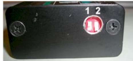
Abbildung 4 DIP-Schalter und Zündkurvenauswahl.
