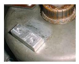
Die Leiterplatte wird mit Hilfe des Abstandshalters auf dem Lichtmaschinenstator montiert.
