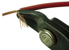
Falls das Kabelende nicht in die Aderendhülse paßt, so kann man ein paar Litzen vom Kabel abtrennen.
