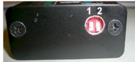
Abbildung 4 DIP-Schalter und Zündkurvenauswahl.
