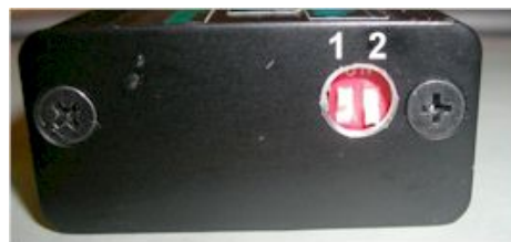
Abbildung 4 DIP-Schalter und Zündkurvenauswahl.
