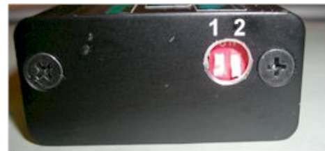
Abbildung 5 DIP-Schalter und Zündkurvenauswahl.
